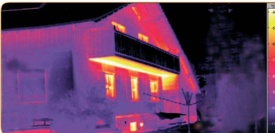
„Balkon in Flammen“: Ganz deutlich tritt hier eine Wärmebrücke zu Tage. Bei diesem Altbau wurden Geschosdecke und Balkonplatte aus einem Stück gegossen. Das ist heute verboten, denn dadurch wird die Umwelt und nicht das Haus beheizt.
